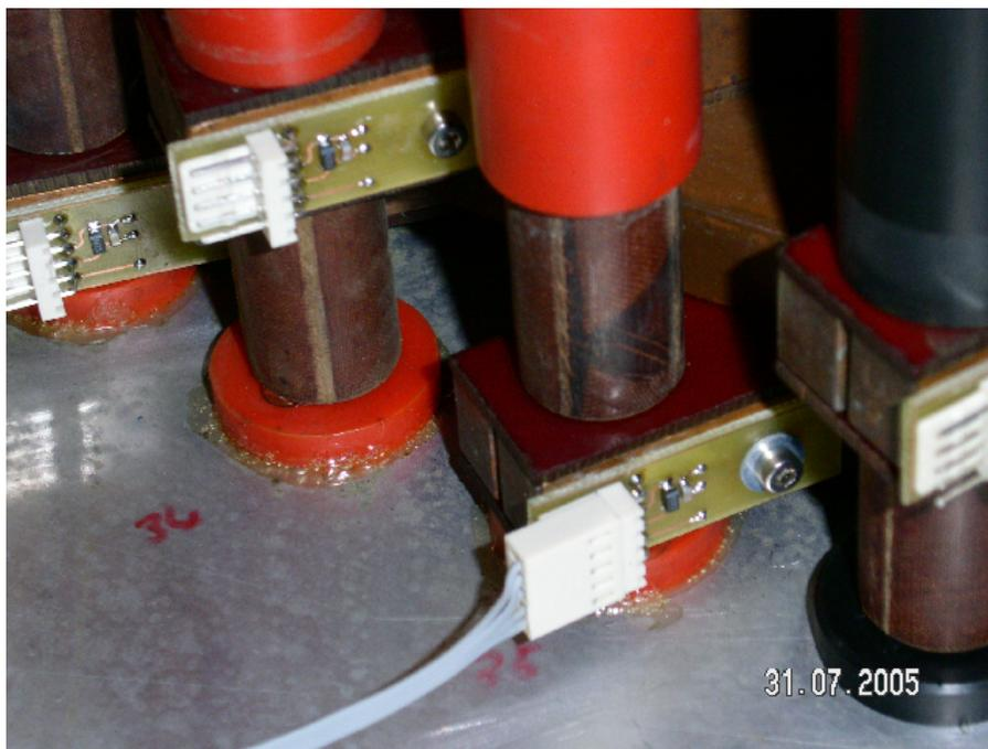
Abbildung 2.10: Temperaturüberwachung durch 12 auf den Spulenquerverbindungen aufsitzenden Meßfühler. Rechts erkennt man zwei der nachgebauten und ausgetauschten neuen Plastikdichtungen in schwarz.
