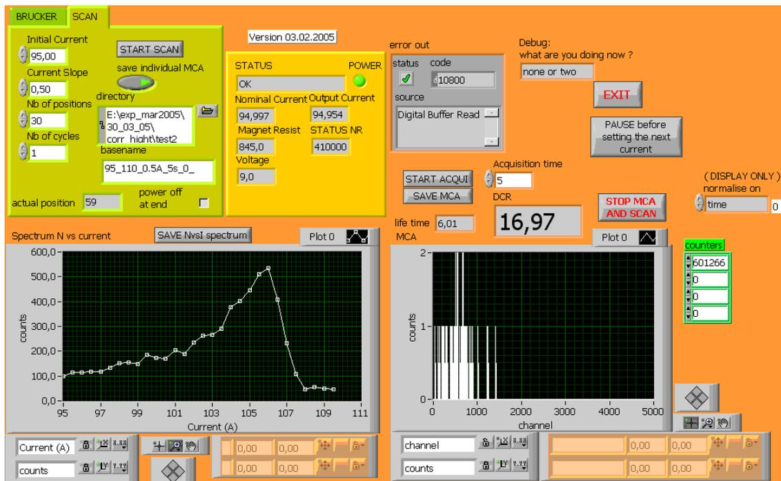
Abbildung 2.11: Steuerprogrammbildschirm nach der Messung des Peaks bei 106 A in idealer Quellposition
